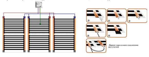
**Изолируйте места подключения.** Для изоляции используйте отрезки битумного скотча. Место установки монтажных «крабов» изолируйте битумным скотчем с двух сторон. Конец отрезанной полосы плёнки изолируйте в местах отреза медных шин, перегнув битумный скотч пополам. Для обеспечения надежной изоляции контактов достаточно плотно обжать руками отрезки битумного скотча. Он легко прилипает и принимает необходимую форму.
